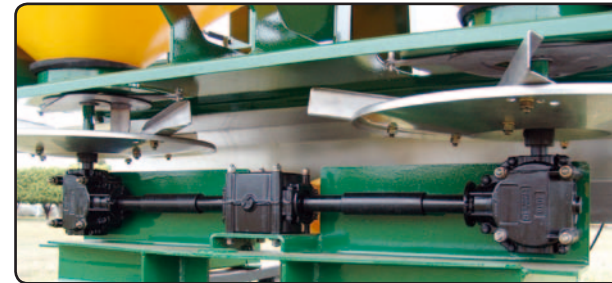
Rotación en el distribuidor: 820 rpm.
